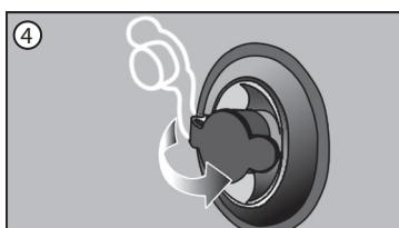
Entfernen Sie die Pumpe vollständig und schließen Sie den externen Stopper. Das Ventil sollte nun in sich selbst eingedrückt sein.
