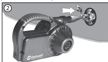
Sæt mundstykket på pumpens oppustningsende. For mundstykket ind i ventilen, og start pumpen.
